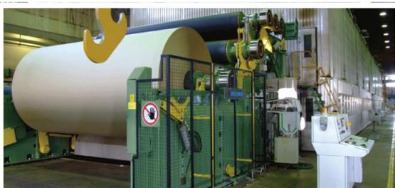
Die Papiermaschine stellt aus dem feingereinigtem Ganzstoff (1 % Feststoff, 99 % Wasser) eine endlose Bahn her, die nach der Aufrollung nur noch 5 bis 9 % Wasser enthält. Moderne Papiermaschinen haben eine Arbeitsbreite von 7,50 Metern und eine Produktionsgeschwindigkeit bis etwa 1000 m/Min.
